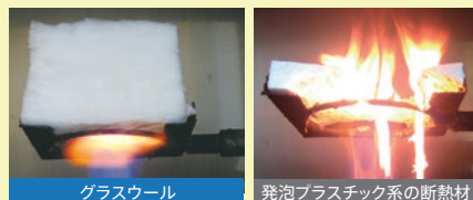
【比較方法】150mm角の試料をセットし、下から炎を当てた後の状態を撮影。
