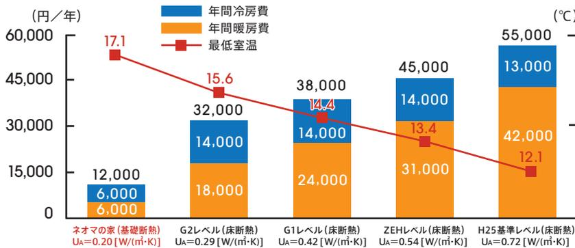
暖冷房費、室内温度シミュレーション設定条件 概要
